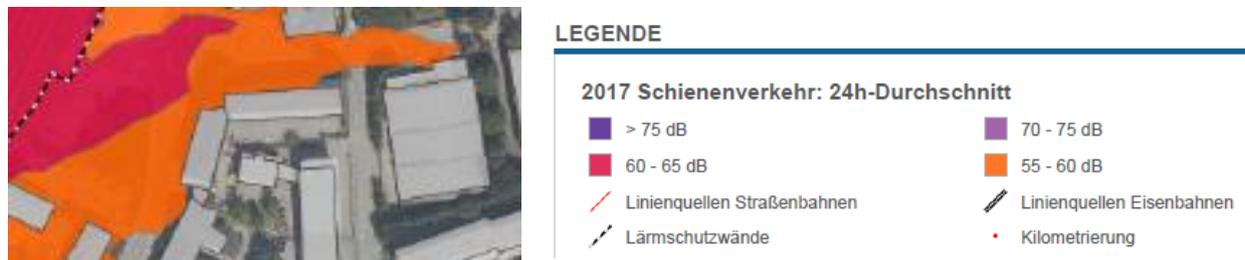
Abb 11: Auszug aus Lärmkarte Schienenverkehr 2017 – 24 h Durchschnitt gemessen in 4 m Höhe über Boden
